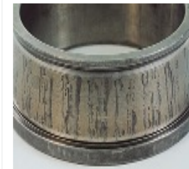
وجود رگه های سیاه مایل به خاکستری در حلقه های داخلی و خارجی به دلیل نفوذ مواد خورنده
