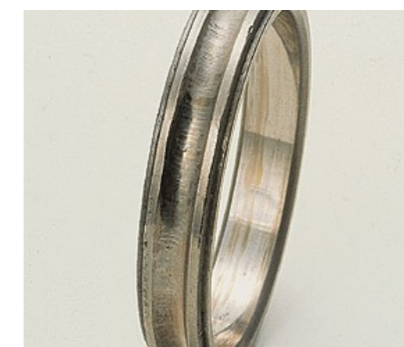
وجود مساحتی قرمز رنگ بر روی حلقه خارجی به دلیل بارهای نوسانی
