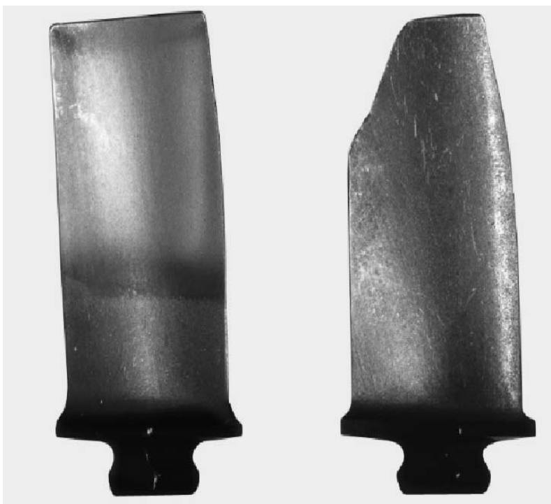
شکل ۳: مقایسه عملکرد یک پره کمپرسور بدون پوشش با پره پوشش داده شده با نانوساختار نیتريد تیتانیوم
