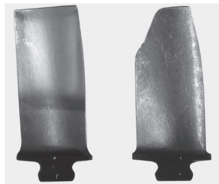
شکل (۵): مقایسه عملکرد یک پره کمپرسور بدون پوشش با پره پوشش داده شده با نانو ساختار نیتريد تیتانیوم
